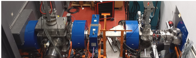
Figure 1: Photograph of the current FRANZ LEBT beamline (Aug. 2022).
